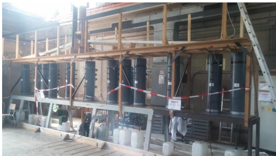
Figure 9 : Disposition des lysimètres.
