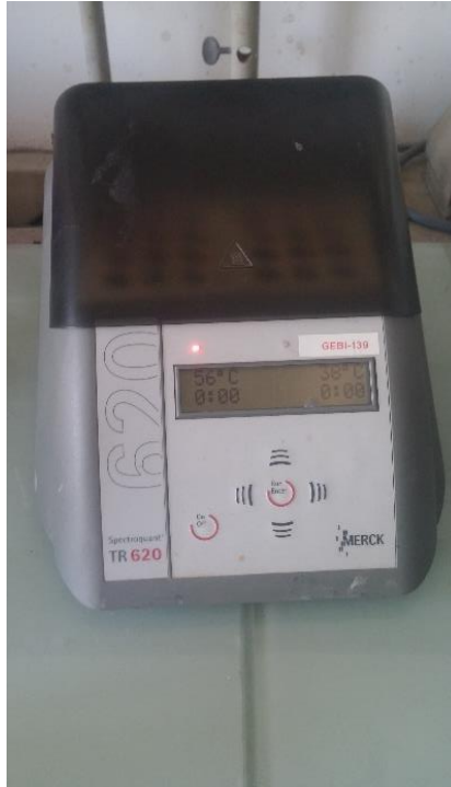
Figure 17 : Thermostat utilisé pour permettre l'oxydation de l'échantillon.
