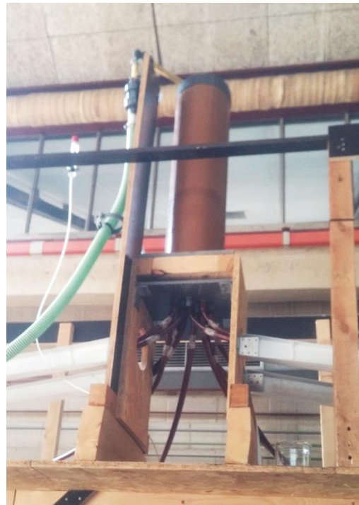
Figure 11 : Réservoir permettant une répartition de volume équitable entre les colonnes.
