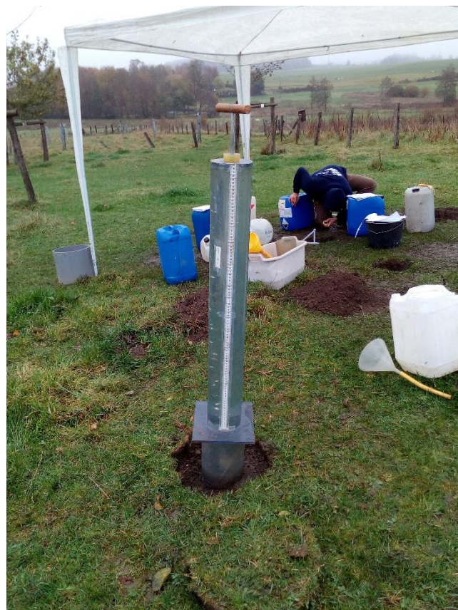
Figure 12 : Infiltromètre à charge constante.
