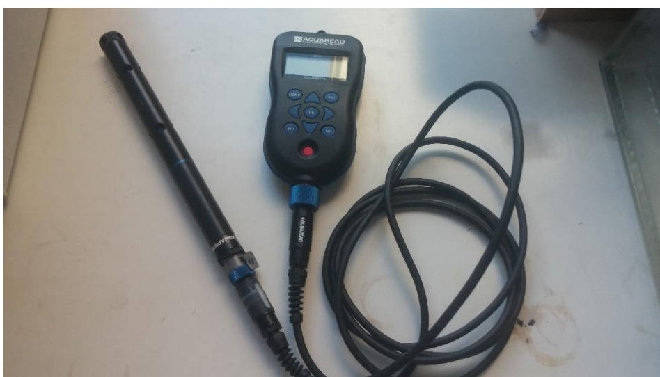
Figure 22 : Sonde optique Aquaprobe lite utilisée pour la mesure de concentration massique de fluorescéine.
