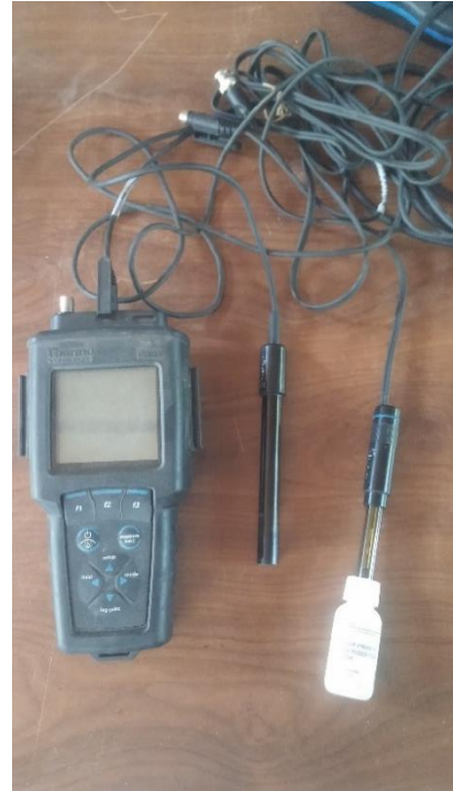
Figure 18 : Sonde à pH et à conductivité électrique ThermoScientific.
