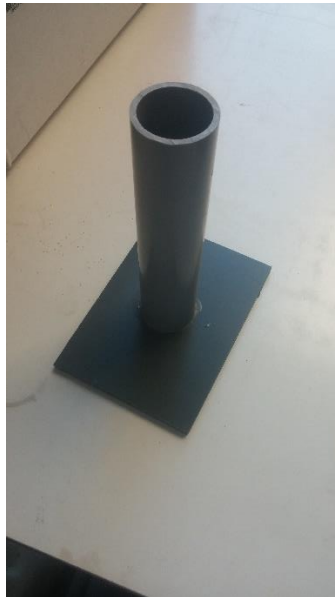
Figure 23 : Récipient en PVC servant à la mesure de concentration massique de fluorescéine.
