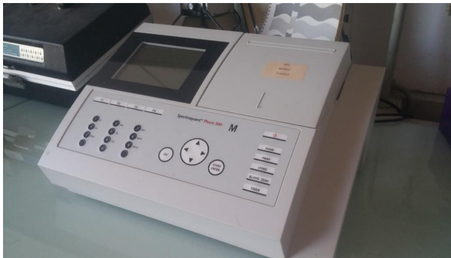
Figure 19 : Spectrophotomètre utilisé pour le dosage des ions \text{Cr}^{3+}
