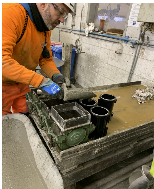
FIGURE 4.7 – Compactage du béton dans les moules sur la table vibrante
