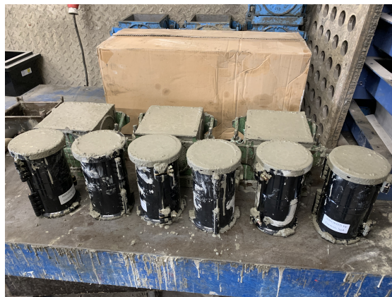
FIGURE 6.4 – 9 moules remplis de béton frais
