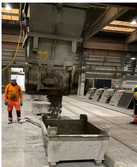
FIGURE 4.6 – Processus de remplissage de béton dans la brouette
