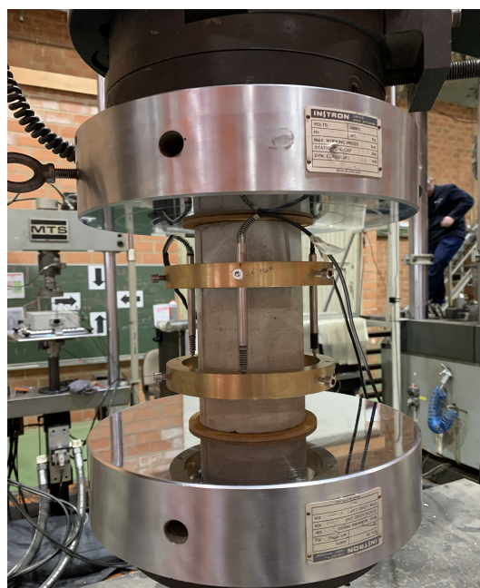
FIGURE 4.11 – Éprouvette avec capteurs entre les 2 plateaux de compression
