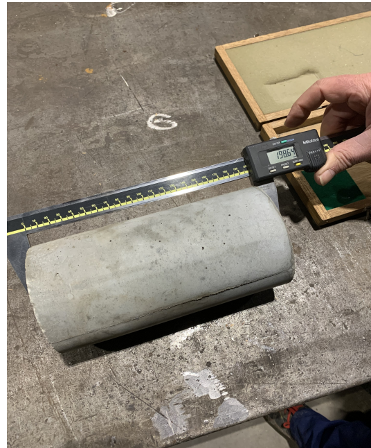
FIGURE 4.9 – Mesure de la longueur du cylindre
