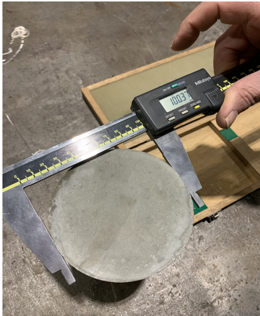
FIGURE 4.8 – Mesure du diamètre du cylindre
