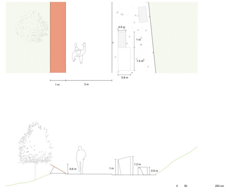
Plan et coupe de la promenade : dimensionnement des équipements
