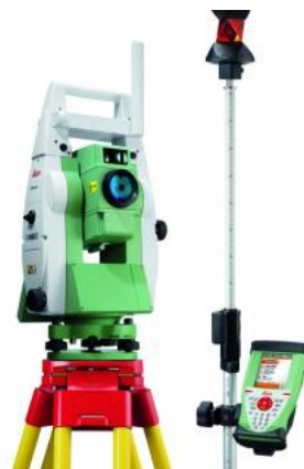
FIGURE B.1 – Station totale avec un prisme ainsi que son support 1
