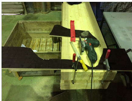
FIGURE 2.4 – Découpage des sections avec une scie sauteuse
