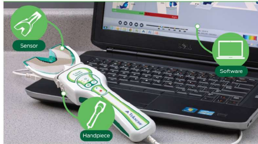
Figure 14: Détail des trois composants du T-Scan de Tekscan [31]
