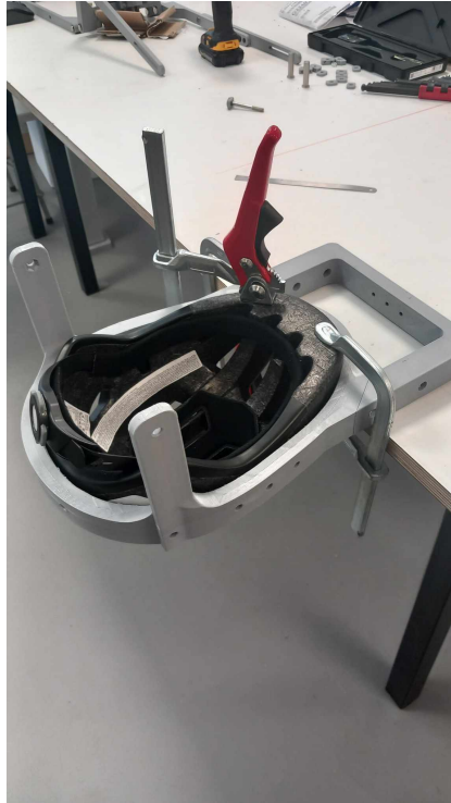
Figure 30: Montage pour le perçage
