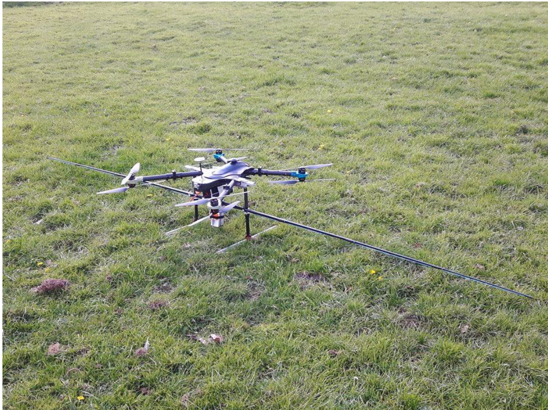
Figure 38: Le drone équipé du géoradar, de son antenne dipôle, de sa batterie et d'un GPS (source personnelle).
