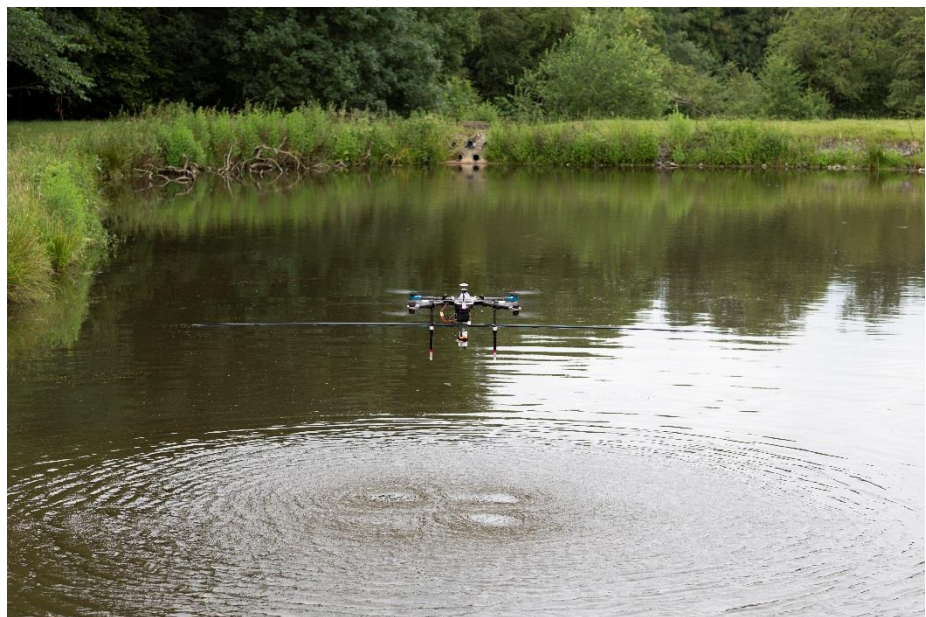
Figure 44: Vol de calibration du radar aéroporté au-dessus d'un plan d'eau.
