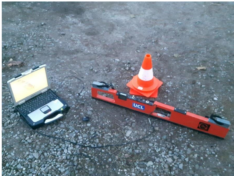
Figure 17: Ordinateur, EM38 et GPS utilisés pour les relevés de conductivité par la méthode de l'induction électromagnétique (source personnelle).
