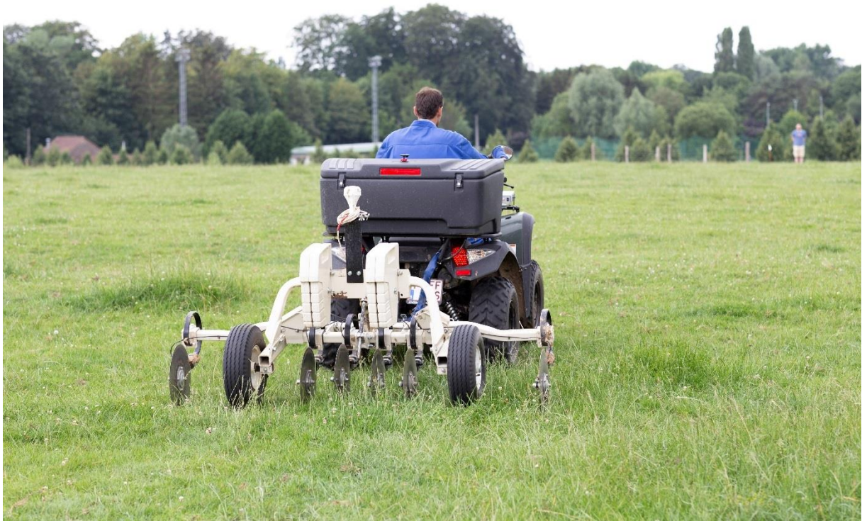
Figure 42: Mesures de la conductivité électrique via la méthode de l'ERT (source personnelle).
