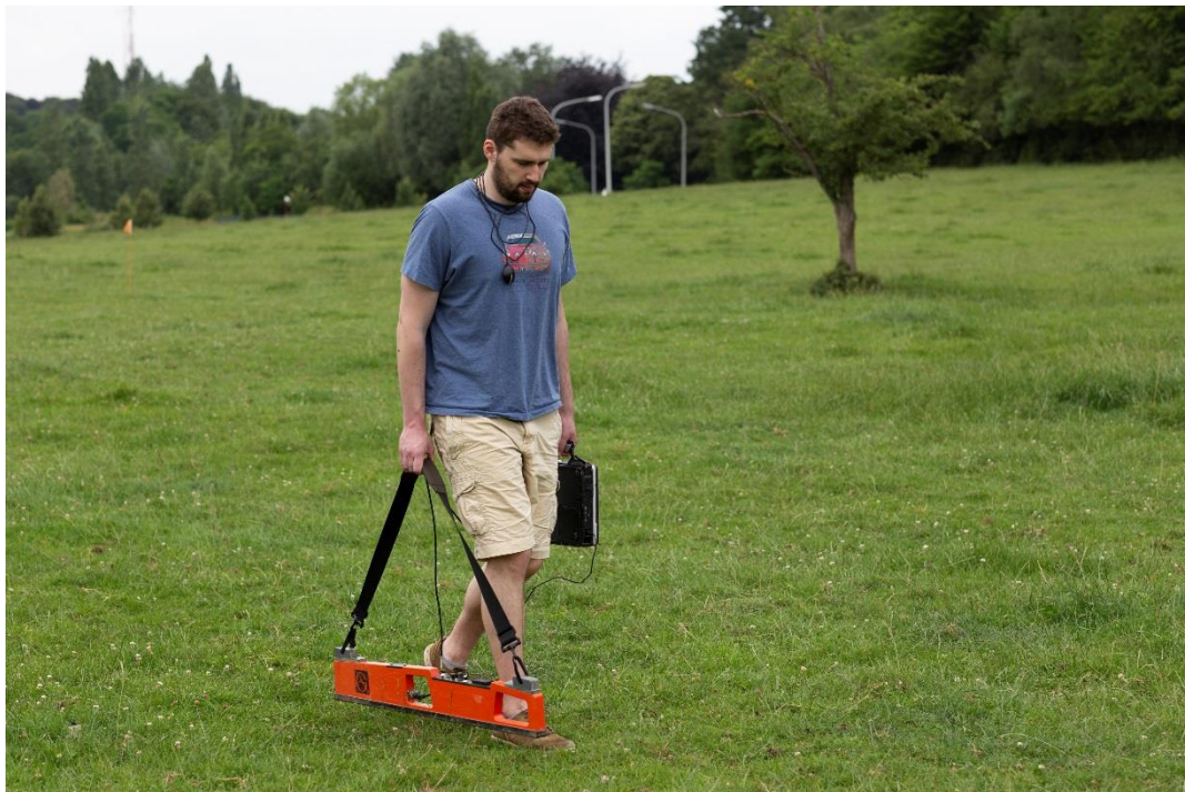
Figure 19: Relevé, à pied, de la conductivité électrique du sol avec l'EM38 (source personnelle).
