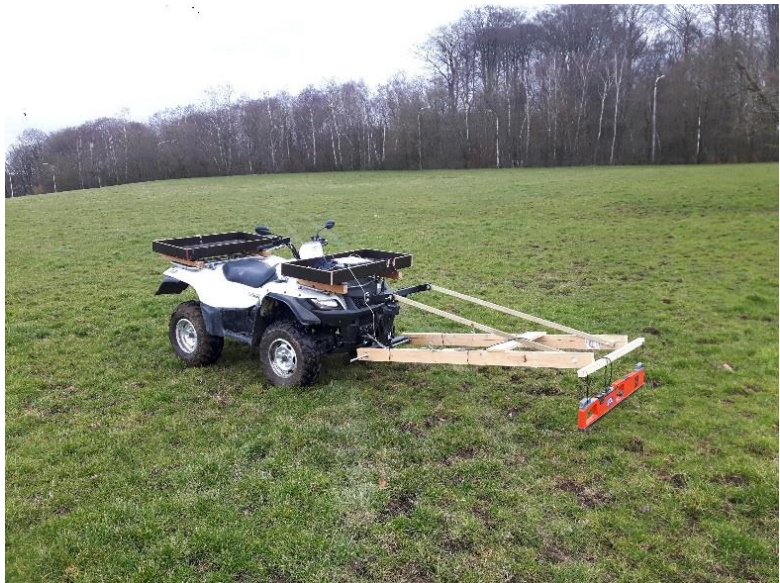
Figure 18: Dispositif mis en place pour les relevés de conductivité réalisé avec l'EM38 sur le quad (source personnelle).
