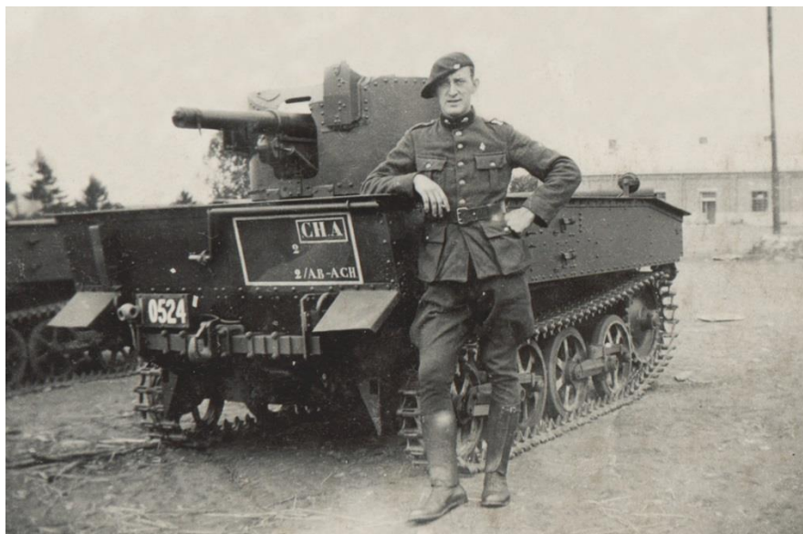
T.13 type I des Chasseurs ardennais. Cet exemplaire n'a pas encore reçu ses plaques de blindage latérales. Il est à noter que, malgré le canon disposé vers l'arrière, celui-ci peut tirer vers l'avant. (Source : Musée des Chasseurs ardennais)
