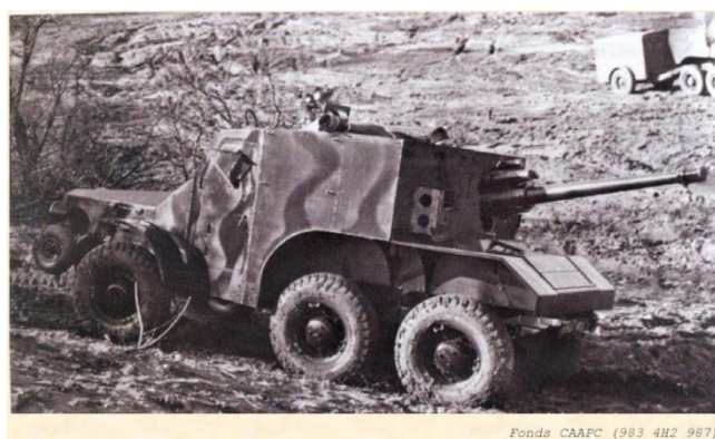
Camion Laffly blindé et armé d'un canon de 47 mm. Produité à partir de 1939, il sera très apprécié par ses équipages lors des combats de mai-juin 1940. (Source : Belgian Tank Museum)
