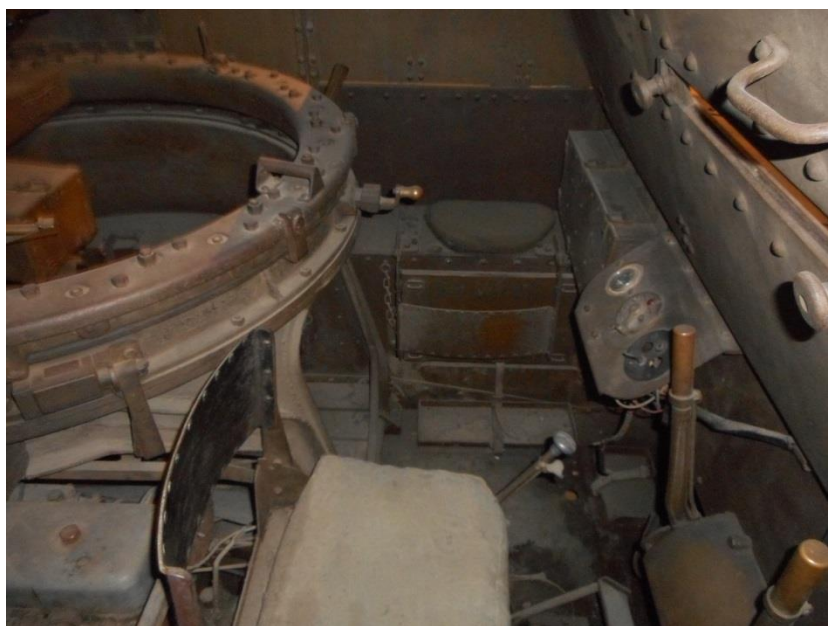
Poste de conduite d'un T.13 type II. On peut remarquer sa rusticité. (Source : photo de l'auteur au MRA)
