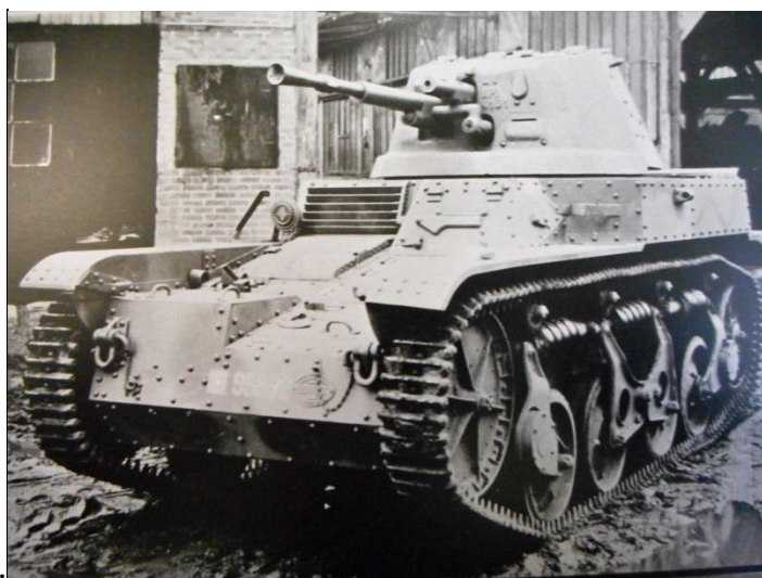
Chenillette antichar française AMR 35 ZT2. Armé d'un canon antichar de 25mm cet engin n'est produit qu'à quelques exemplaires. (Source : Belgian Tank Museum)
