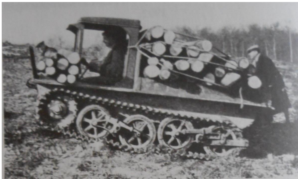
Tracteur Vickers-Carden-Loyd destiné à l'agriculture. Remarquons le train de roulement presque semblable à celui des T.13 types I et II. (Source: HACKER O. H. e.a., Heigl's Taschenbuch der Tanks , Vol. I, Munich, Lehmanns, 1935, p. 130.)
