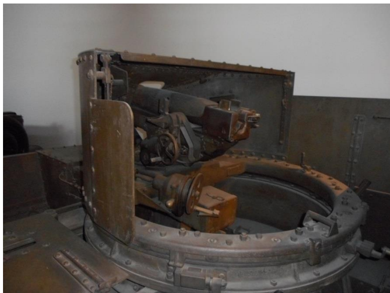
Poste de tir à bord d'un T.13 type II. Théoriquement, il doit accueillir le pointeur et le tireur. On peut remarquer l'exiguïté de cet espace, ainsi que la place prise par les volants de pointage. (Source : photo de l'auteur au MRA)
