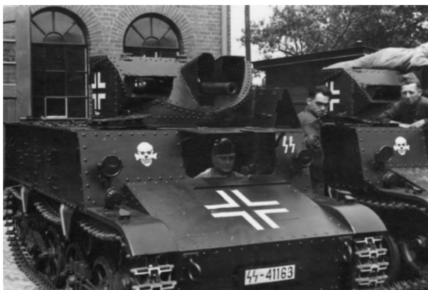
T.13 équipant une unité de SS (peut-être la SS Totenkopf ?). Nous constatons la couleur grise de l'engin, les grandes croix balkaniques allemandes, ainsi que la plaque militaire du véhicule. Les phares en verre ont été transformés en phares de black-out. (Source : https://www.pinterest.com/pin/380272762264488477/ (page consultée le 27/09/2016))
