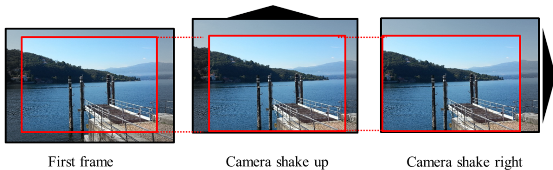
FIGURE 2.5 – Représentation du mouvement de la caméra et de la compensation qui mène à une vidéo stabilisée. Figure issue de [15]
