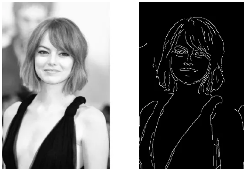
FIGURE 5.7 – Illustration de la méthode de Canny. Les gradients de forte intensité filtrés par l'hystérèse sont présentés sur l'image de droite. On remarque que ces gradients correspondent bien aux bords présents sur l'image. Image issue de [50].
