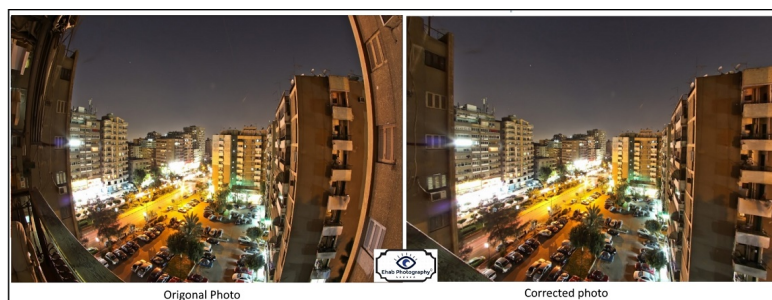
FIGURE 2.6 – Illustration de la distorsion due à la lentille de la caméra. Sur la gauche, la version rectifiée de la même image. Figure issue de [20]
