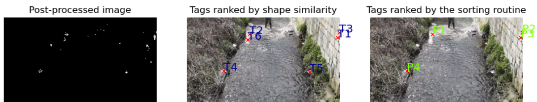
FIGURE 5.29 – Résultats de la méthode de détection automatique des balises sur le jeu de données de Noirath. La première figure montre la première frame avec les étapes de post-processing. La seconde figure montre les balises triées par ordre croissant de distanceMatching (définie dans l’Eq. (5.12)). La dernière figure montre les balises triées avec la méthode définie dans la Section 5.5.7
