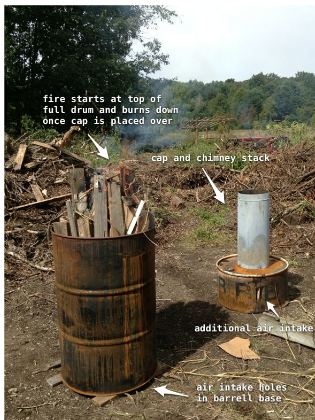
FIGURE 14.1 – Four pour biochar de type Top-lift Updraft (TLUD). (Source : Appropedia.org, 2015)
