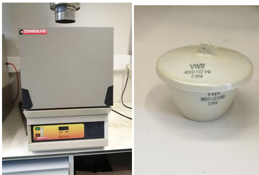
Figure 15. Four à haute température (gauche) et creuset contenant du charbon fermé par un couvercle (droite)
