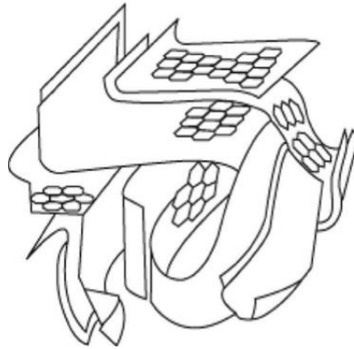
Figure 4. Structure des feuillets graphitiques d'un charbon actif
