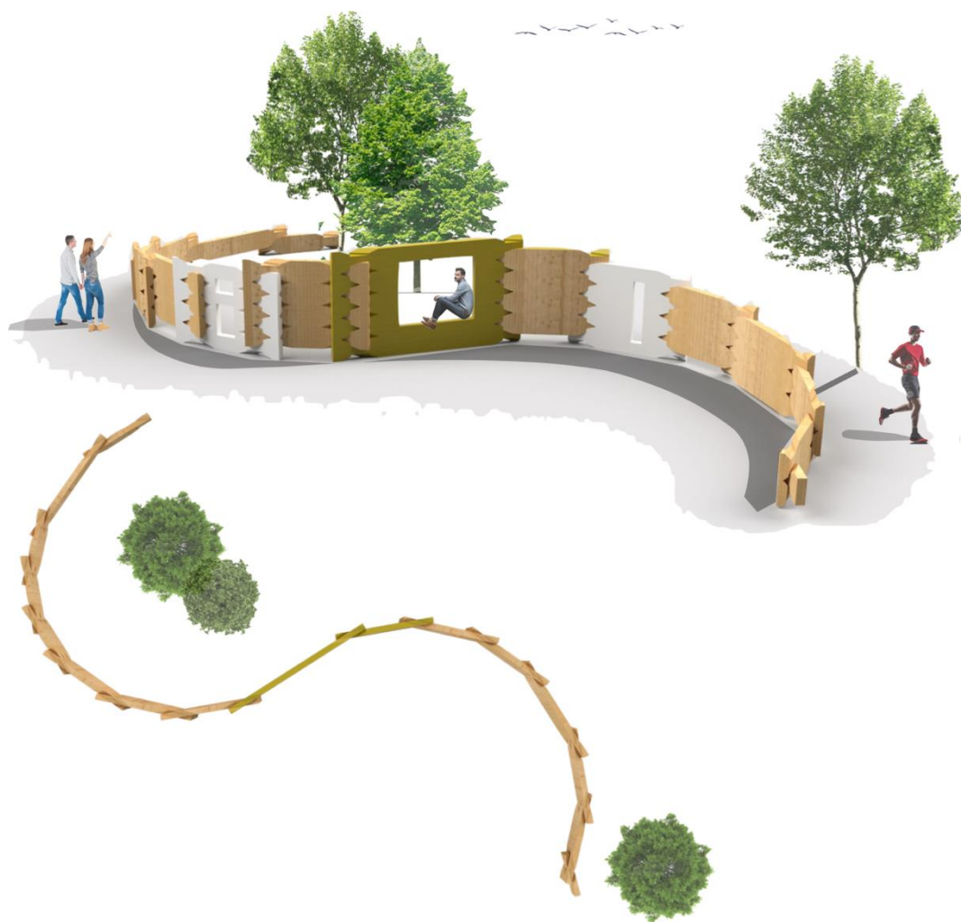
Figure 128 : structure ondulée réalisée à l'aide d'éléments drone-compatibles
