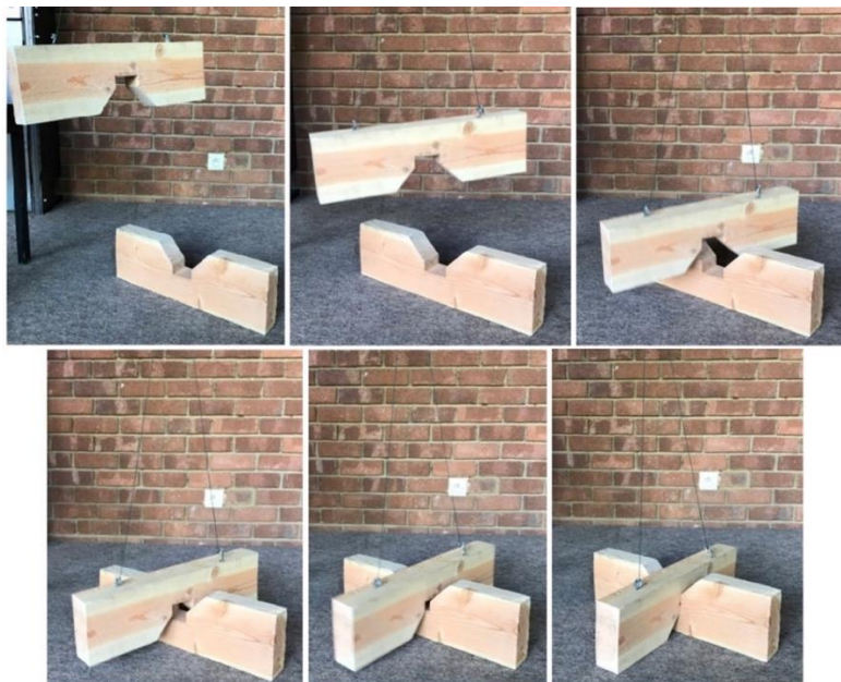
Figure 45 : séquence d'assemblage des éléments à la main
