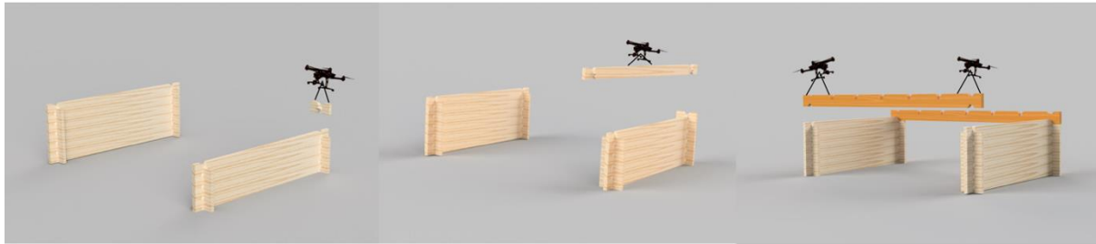
Figure 63 : séquence de montage par drone
