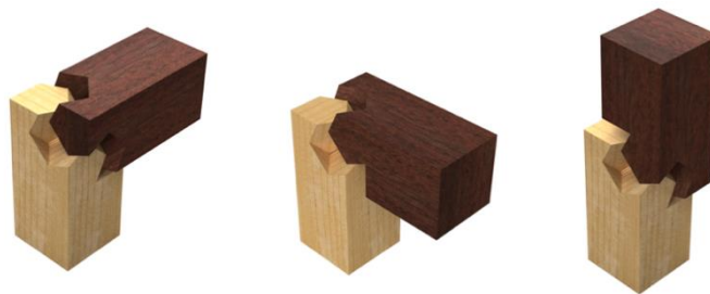
Figure 115: la forme traditionnelle du kawai tsugite permet d'assembler deux éléments identiques axialement ou perpendiculairement.
