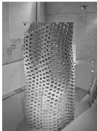
Figure 2 : tour de 6m de haut construite à l'aide de quadricoptères autonomes
