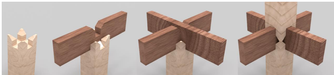
Figure 81 : séquence de montage ; joint de type 1
