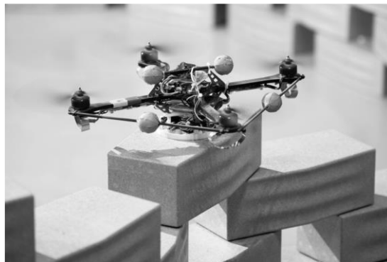
Figure 1 : pose d'un module par un quadricoptère autonome
