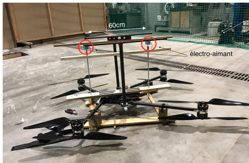
Figure 50 : système de levage fixé au drone
