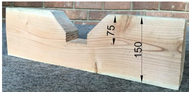
Figure 44 : photo d'un modèle réduit réalisé pour des essais de mise en place à la main, [mm]
