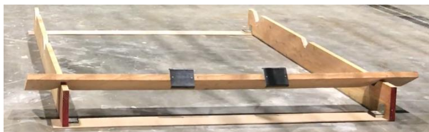
Figure 54 : basculement de la poutre n°4 (encoche sur un quart de la hauteur) dû au vent créé par le drone
