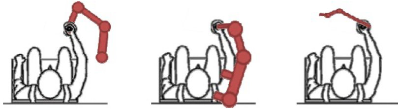
FIGURE 1.6 – Comanipulation - parallèle, orthétique, série [25]
