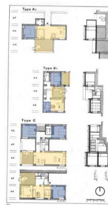
Figure 46 : Plans et coupes des différents types de module du projet Habitat 67 (source : pixshark.com )
