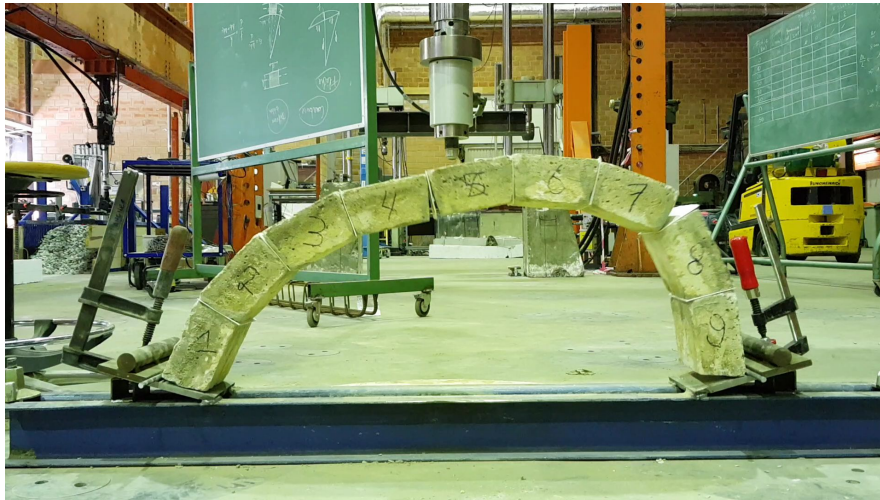
FIGURE 2.33 – Ruine par perte d'équilibre de l'arc en pavés Blanc de Bierges - téflon (essai 2)
