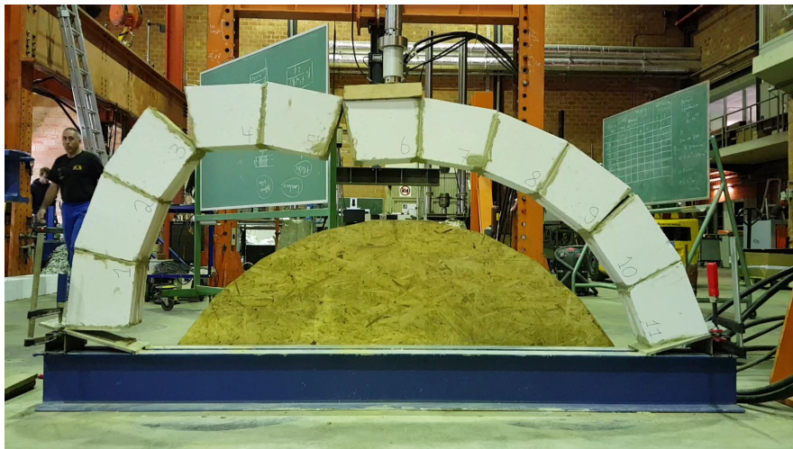
FIGURE 2.29 – Ruine par perte d'équilibre de l'arc en blocs Ytong - mortier à la chaux 1 jour (essai 3)
