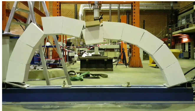
FIGURE 2.21 – Rupture locale en clé de voûte - mode 1
