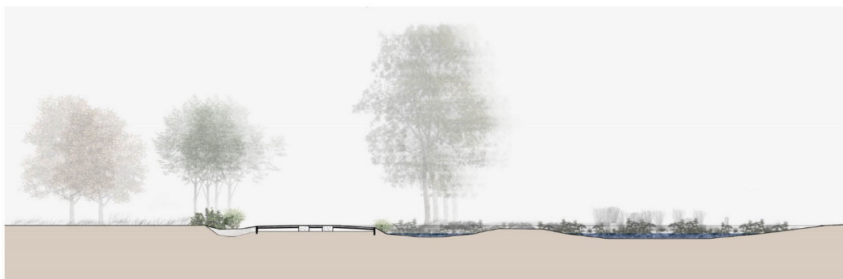
La voie mixte logistico-piétonne et son bassin de rétention d'eau aménagé
