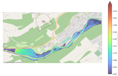
FIGURE 5.19 – Simulation de l'écoulement avec comme débit celui maximal pour un temps de retour de 25 ans ( 107.03m^3/s ) et une digue de 2 mètres avec 0.06 comme coefficient de Manning.
