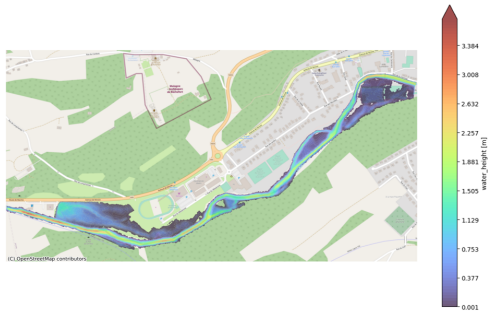
FIGURE 5.18 – Simulation de l'écoulement avec comme débit celui maximal pour un temps de retour de 5 ans ( 49.98m^3/s ) et une digue de 2 mètres avec 0.06 comme coefficient de Manning.
