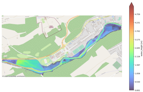
FIGURE 5.20 – Simulation de l'écoulement des sports avec comme débit celui maximal pour un temps de retour de 50 ans ( 139.85m^3/s ) et une digue de 2 mètres avec 0.06 comme coefficient de Manning.
