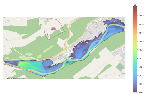
FIGURE 5.11 – Simulation de l'écoulement avec comme débit celui maximal pour un temps de retour de 25 ans ( 107.03m^3/s ) avec 0.06 comme coefficient de Manning.
