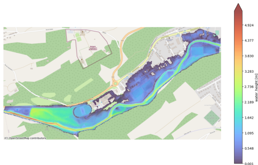
FIGURE 5.12 – Simulation de l'écoulement avec comme débit celui maximal pour un temps de retour de 50 ans ( 139.85m^3/s ) avec 0.06 comme coefficient de Manning.
