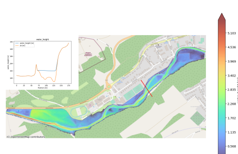
FIGURE 5.21 – Simulation de l'écoulement avec comme débit celui maximal pour un temps de retour de 100 ans ( 178.62m^3/s ) et une digue de 2 mètres avec 0.06 comme coefficient de Manning.
