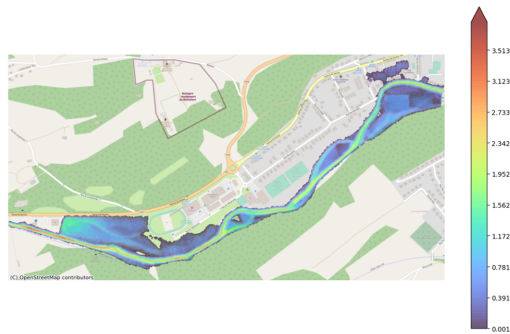
FIGURE 5.10 – Simulation de l'écoulement avec comme débit celui maximal pour un temps de retour de 5 ans ( 49.98m^3/s ) avec 0.06 comme coefficient de Manning.
