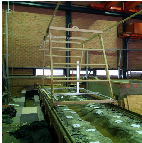
(a) Cage sur rails avec profilés en aluminium.
