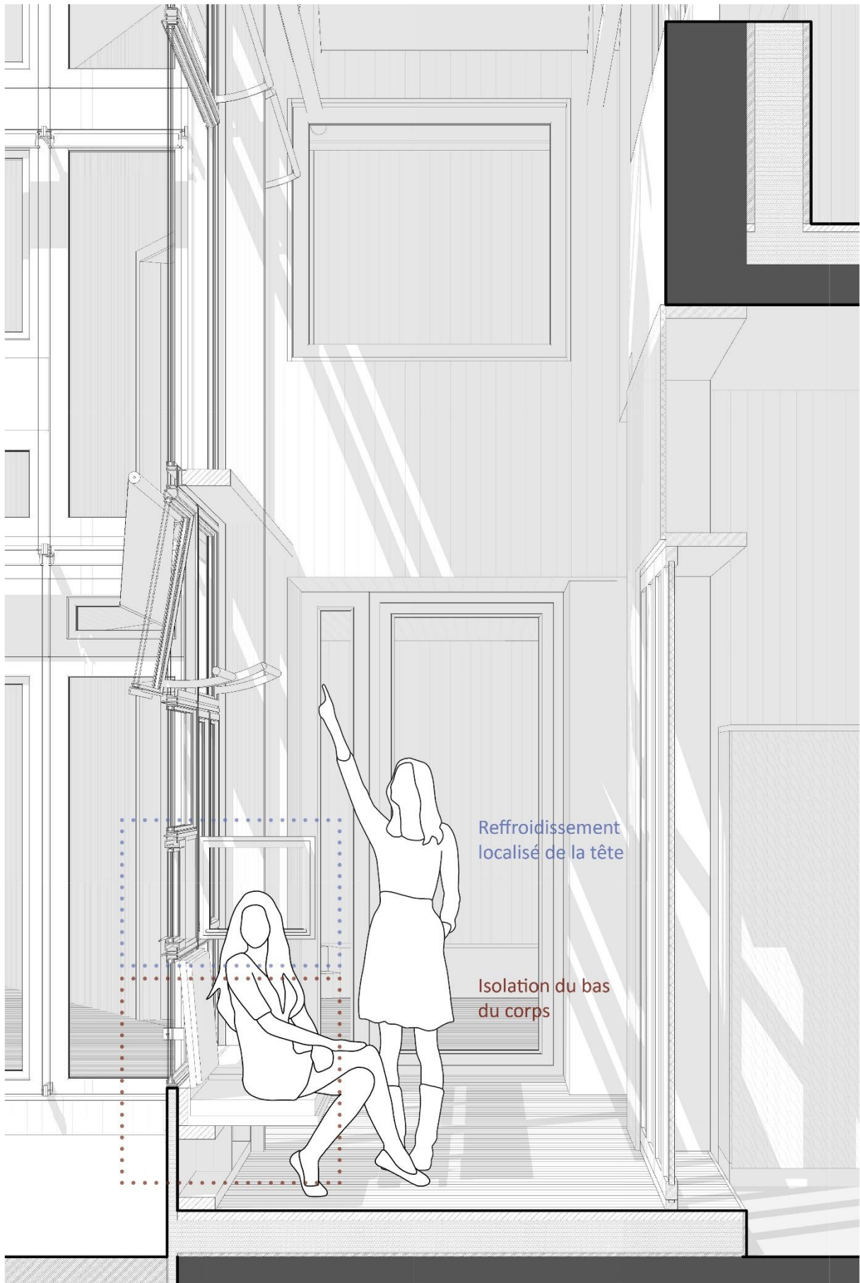
Figure 27 : Assise isolée et ventilation localisée
