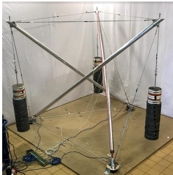
Figure 18 – Système de chargement du « SIMPLEX – masses pendues » [19]
