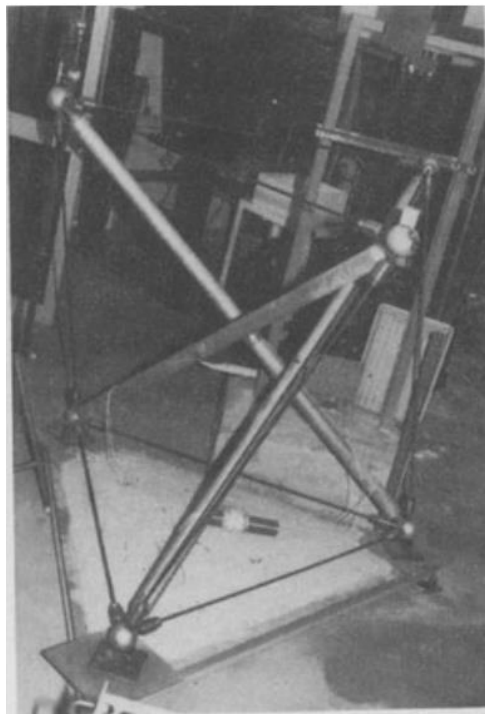
Figure 38 – Prototype pour l'étude statique et dynamique effectuée par MOTRO [29]
