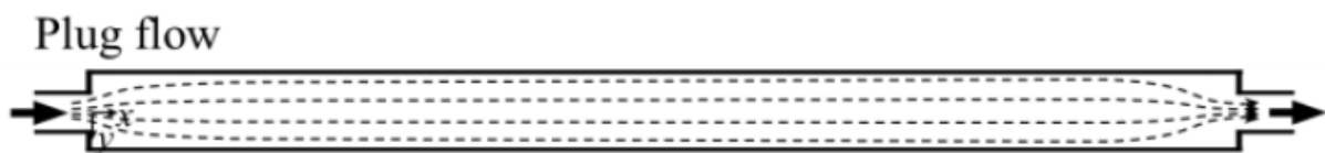
Figure 48 : Forme de l'écoulement de type plug flow
