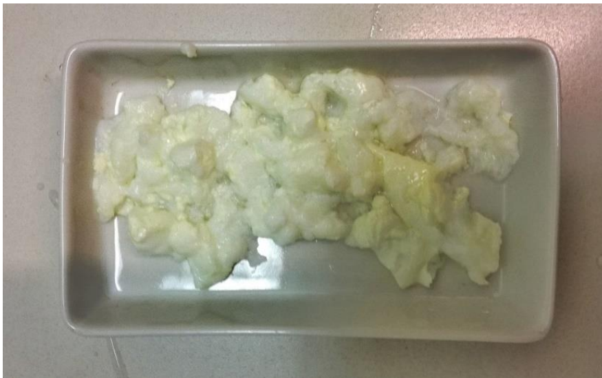
Figure III.10 : Précipité obtenu pour les différents ratios Bi/Mo plasmasynthétisés ayant subi une PD
