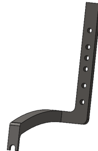
FIGURE 2.45 – Glissière de réglage en hauteur du système
