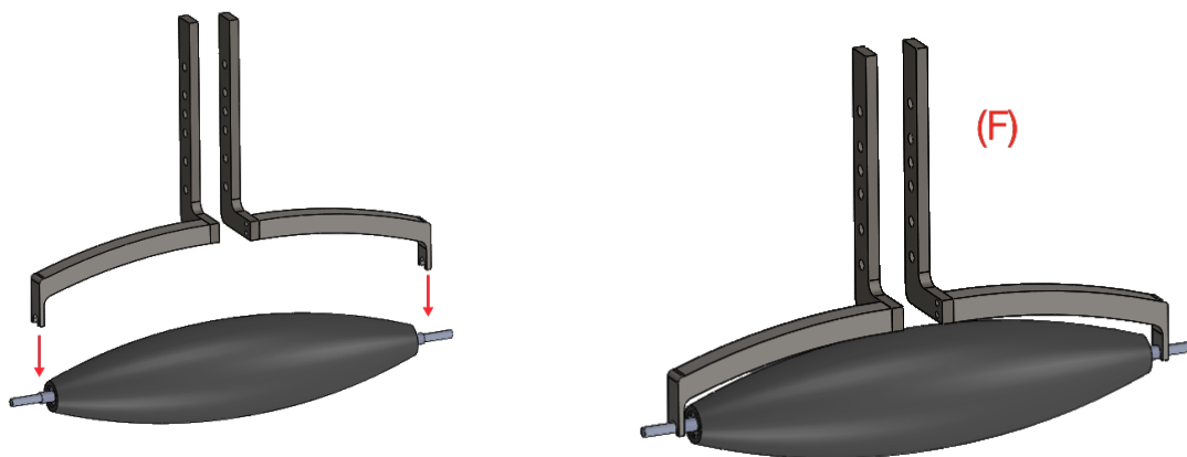
FIGURE 2.87 – Assemblage des glissières de réglage vertical (F)
