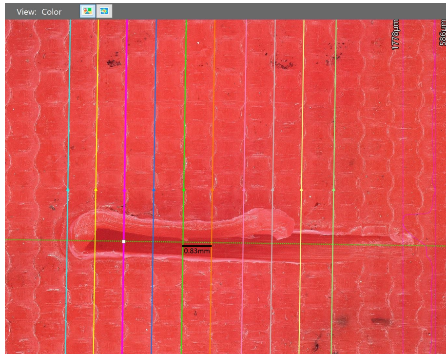
FIGURE 3.4 – 12 sections transversales équidistantes
