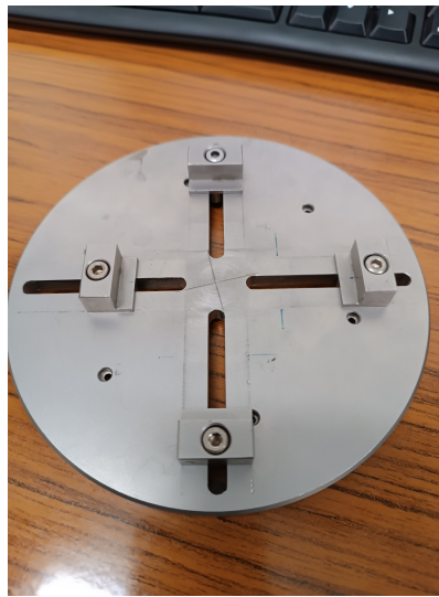
FIGURE 3.1 – Système permettant la fixation à la table de test du tribomètre.
