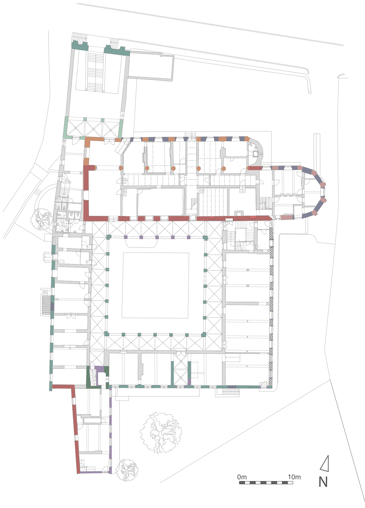
FIGURE 156 Plan du rez-de-chaussée de l'ancien couvent - proposition de plan chronologique. Relevé et plans : bureau Ciplat sa, M. Vanel - Infographie et proposition : M. Vanel
