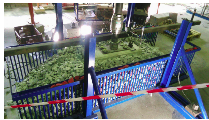
FIGURE 1.1 – Expérience du tassement verticale en laboratoire de l'UCL
