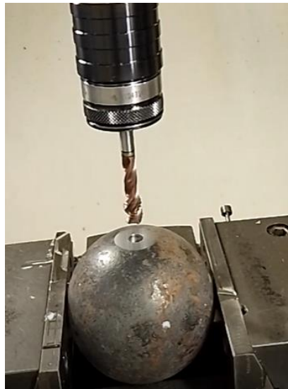
FIGURE G.1 – Réalisation du premier trou taraudé
