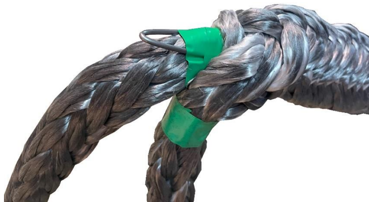
FIGURE C.9 - Entrée de l'extrémité de la corde dans l'âme creuse
