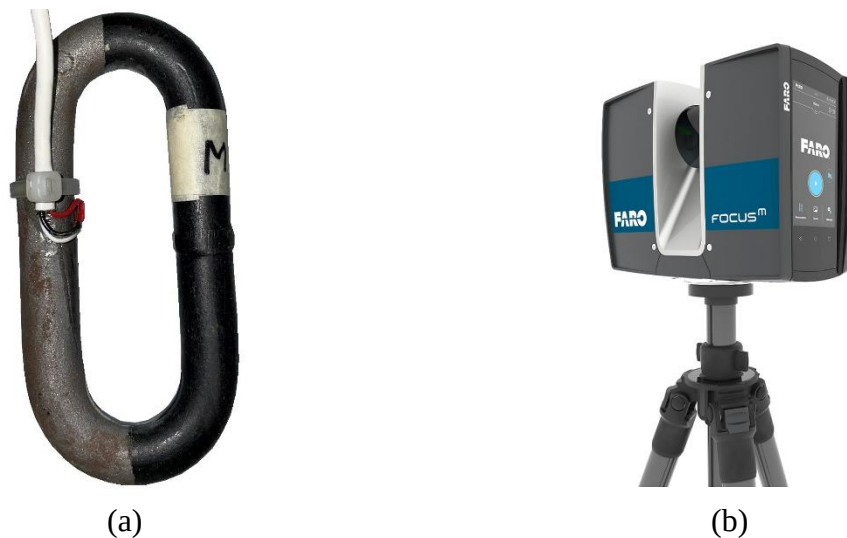
FIGURE 3.1 – (a) Capteur de force fabriqué pour le projet [illustration de l'auteur] (b) Scanner 3D Faro M70 [26]
