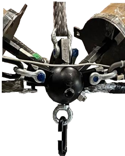
FIGURE 2.20 - Dispositif chargement d'un nœud (BT7) [illustration de l'auteur]
