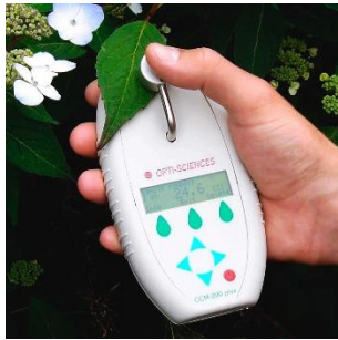
Figure 17 : Chlorophyllomètre CCM200plus (ADC BioScientific Ltd, 2017)
