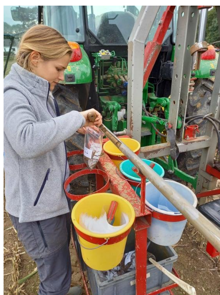
Figure 24 : Echantillonnage des carottes de terre sur le terrain, tarière à l'horizontale.
