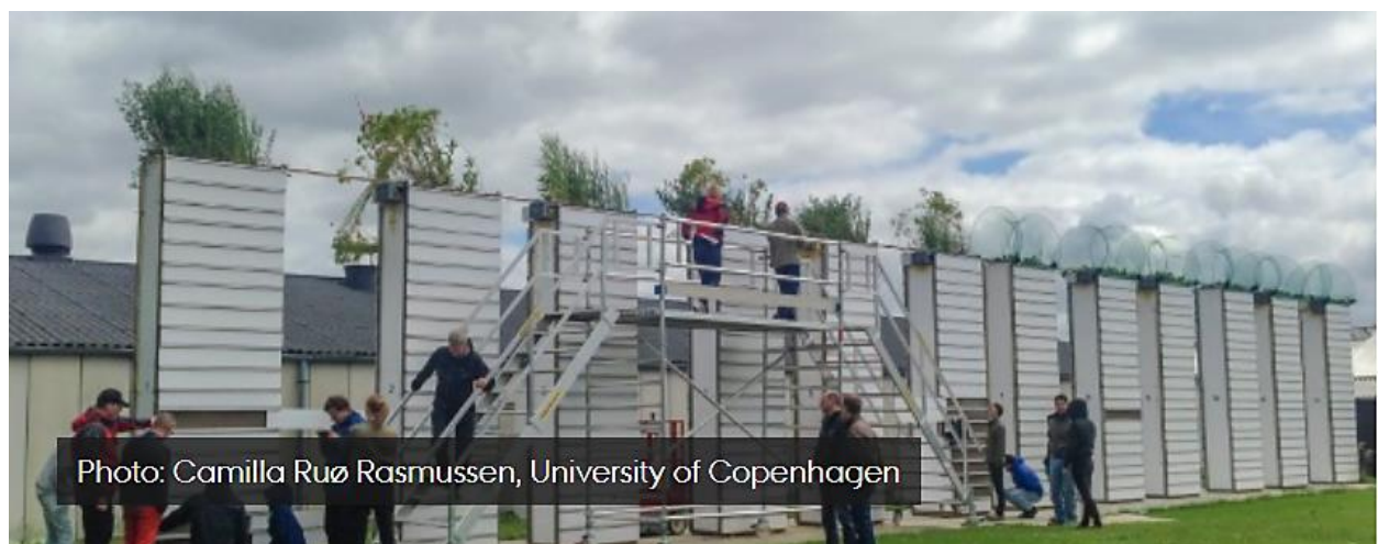
Figure 3 : Photographie de l'expérience des tours à Taastrup (Danemark). L'installation consiste en 12 rhizotrons de 4 m de hauteur, rempli de terre et chacun divisé en deux compartiments. Photographie réalisée dans le cadre du projet « Deep Frontier » (université de Copenhague).
