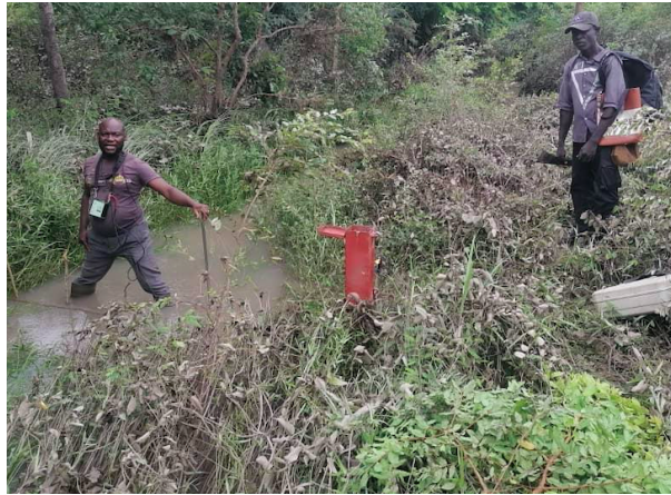
FIGURE 10 – Sonde limnimétrique automatique à l'exutoire (dans le dispositif métallique rouge)
