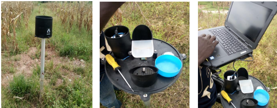
FIGURE 13 – Téléchargement des données de précipitations au niveau du pluviomètre automatique, Source : Équipe BAFONBE Bénin, Université de Parakou, Observation de terrain, 2020
