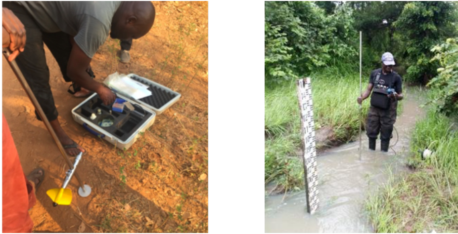
FIGURE 12 – Montage du courantomètre à hélice et mesure de la vitesse de l'eau
