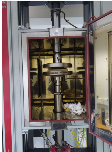
FIGURE 2.3 – Machine de compression ZwickRoell Z250 montée avec étuve [36]
