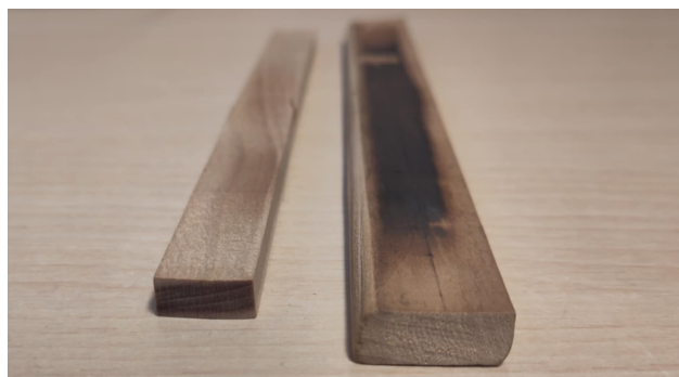
FIGURE 2.7 – Echantillons Carrés densifiés à 170°C et 200mm/min après usinage (gauche) et avant usinage (droite)
