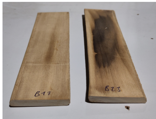
FIGURE 3.8 – Noircissement sur la surface d'échantillons densifiés à 170°C à 4mm/min (gauche) et 200mm/min (droite)
