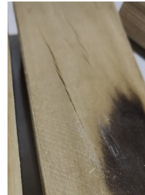
(b) Endommagement sur la surface supérieure
