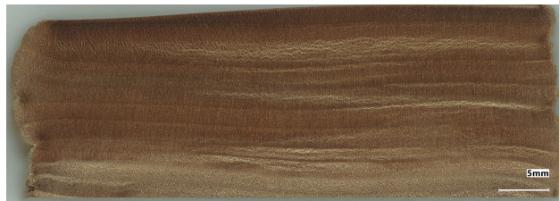
(b) grand carré densifié à 170°C et 200mm/min
