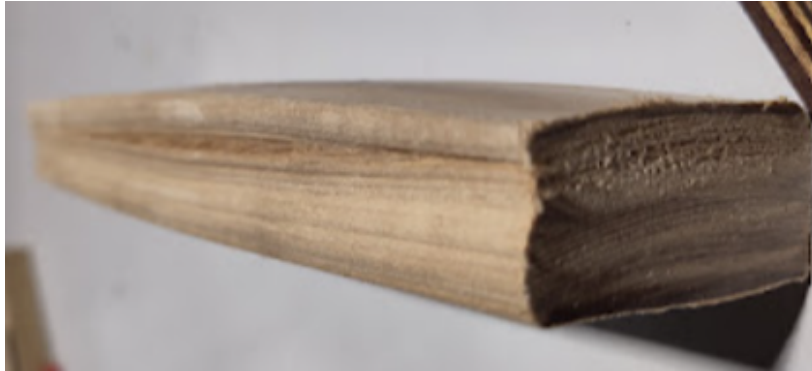
(a) Endommagement sur la surface latérale
