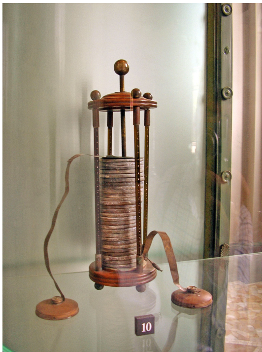
FIGURE 2.3: Volta's electric pile on display in the Tempio Voltiano in Como [21].
