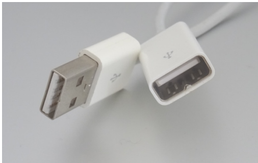
Figure 25 : Détrompeur USB (la languette blanche à l'intérieur du port USB, empêche de le brancher à contre sens).
