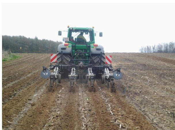
Figure 1 : Strip-tiller utilisé dans le cadre de l'essai – source : CIPF
