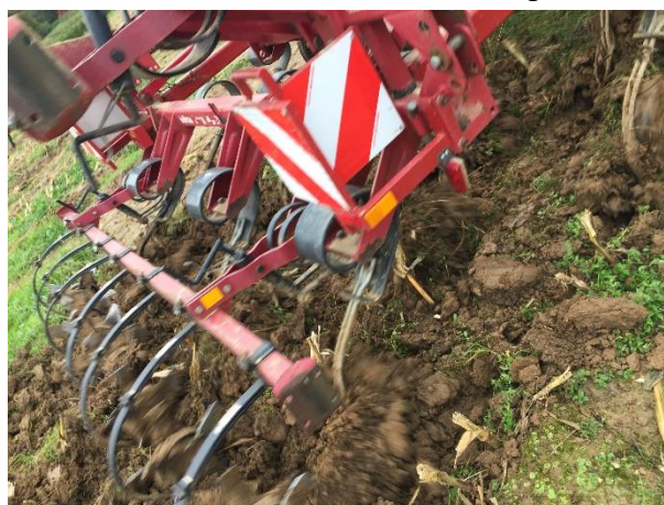
Figure 22 : Vibroculteur utilisé dans le cadre de l'essai au niveau des parcelles de témoin et de strip-till – source : T. Clément (UCLouvain)
