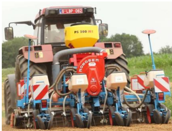
Figure 6 : Combiné de semis adapté pour l'implantation de sous-semis – source : CIPF
