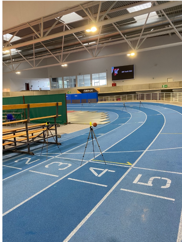
Annexe 1 - Disposition des barrières de cellules
