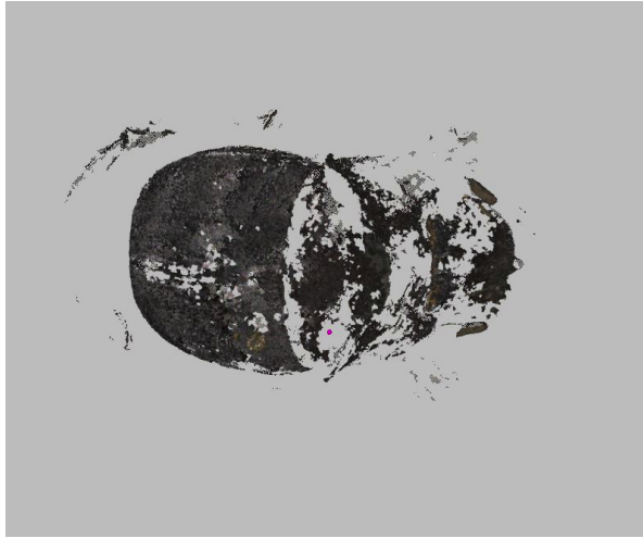
Figure 1: image d'un scan raté d'un heliocopris à cause de sa couleur noire
