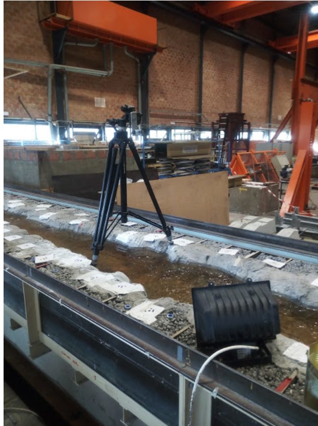
FIGURE 2.3 – Dispositif utilisé en laboratoire pour la PIV
