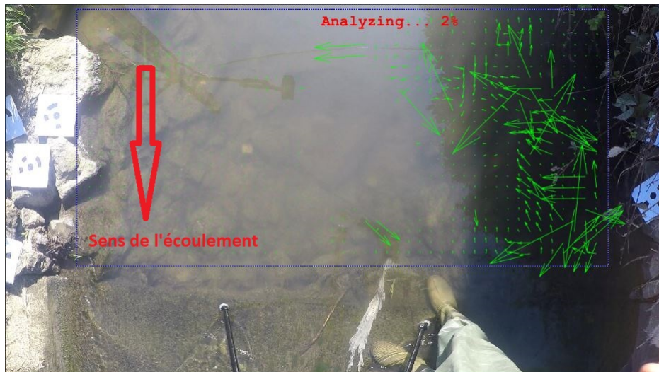
FIGURE 4.13 – Analyse LSPIV sans ensemencement sur la Ligne
