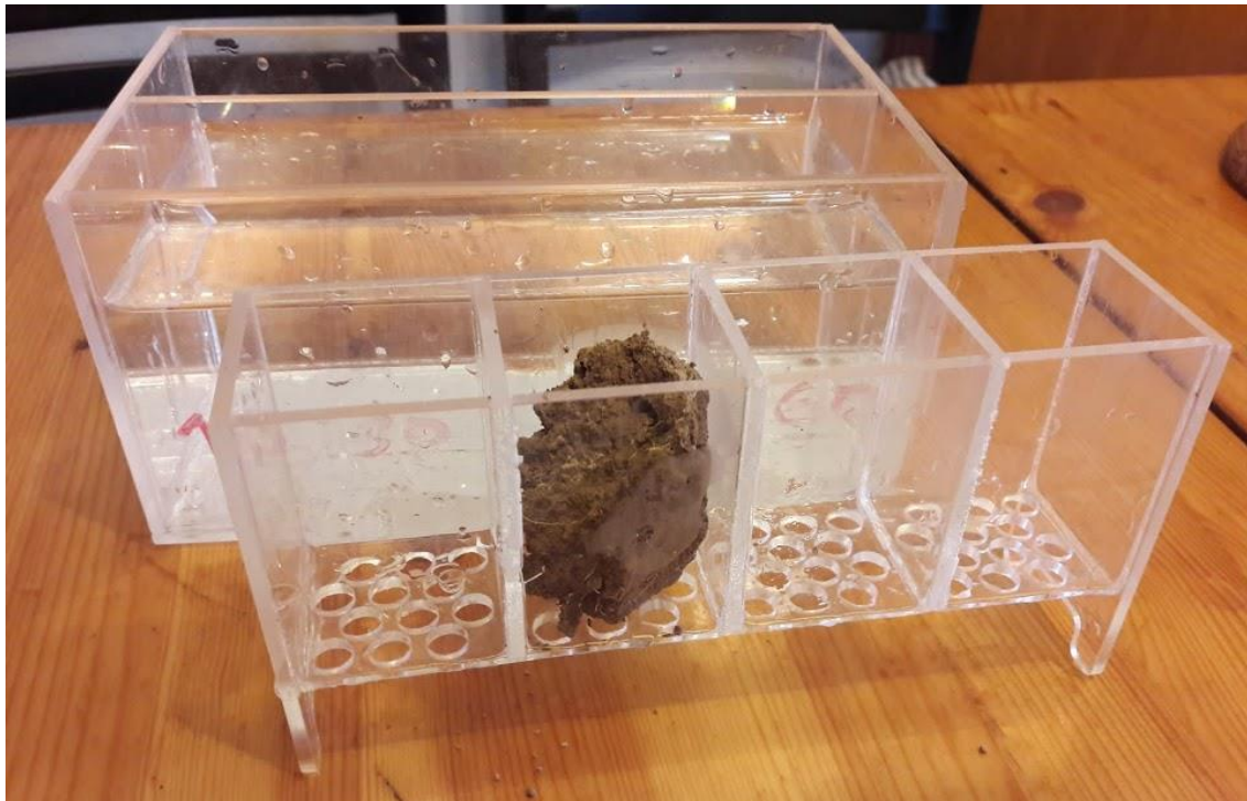
Figure 11: Matériel utilisé pour le slake test. Avant-plan : casier à mottes ; arrière-plan : réservoir d'eau dans lequel est plongé le casier.
