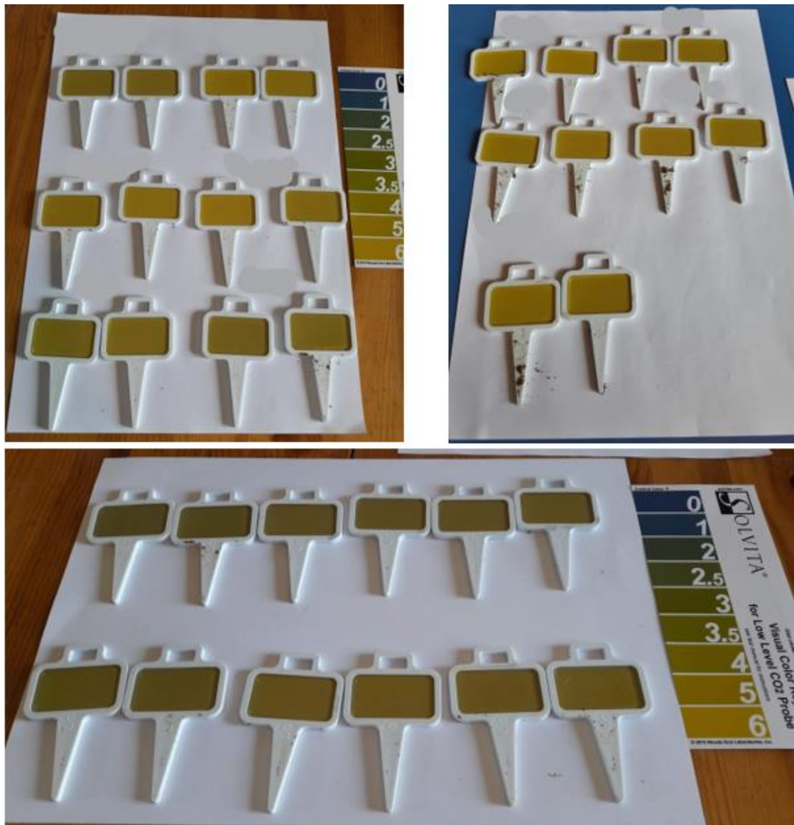
Figure 22: Sondes Solvita ® après 24h de réaction au dioxyde de carbone libéré par des échantillons de sol.
