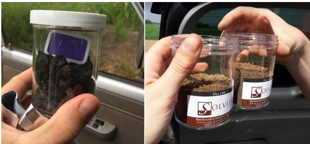
Figure 26: Solvita® Field Test sans (gauche) et avec (droite) tamisage du sol prélevé.
