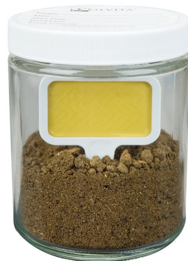
Figure 12: Bocal hermétique Solvita contenant un échantillon de sol et une sonde réagissant au dioxyde de carbone
