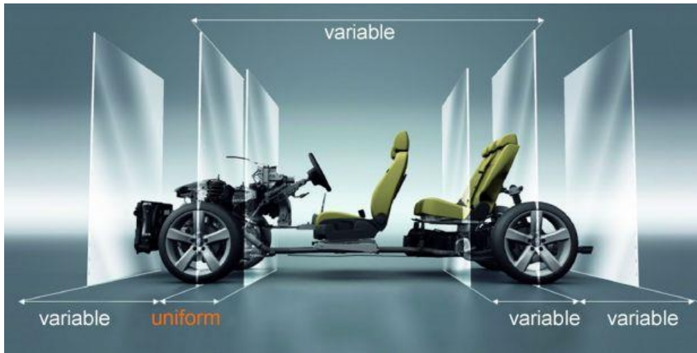
Figure 19 - Plateforme modulaire commune (Source : Avatacar, 2021)
