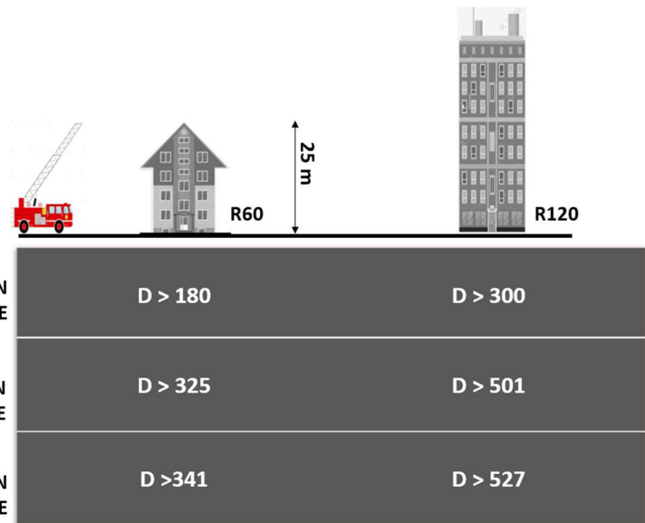
Figure 6-4 Rupture par flambement, diamètre de colonnes minimum pour une tenue au feu
