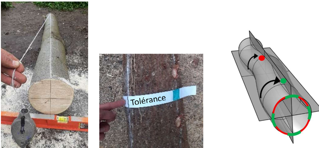
Figure 9-4 Photos et schéma : gestion des formes organiques des troncs
