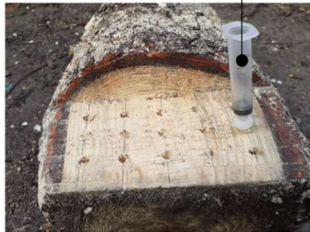
Figure 9-6 Photos renfort par injections de résine
