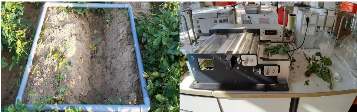
Figure 21: Photo illustrant les étapes de la réalisation de la mesure du GAI. De gauche à droite : Prélèvement d'1m 2 de biomasse à l'aide d'un cadre en plastique ; passage au scanner de l'ensemble de la biomasse récoltée. (Auteur : Florent Matheise)
