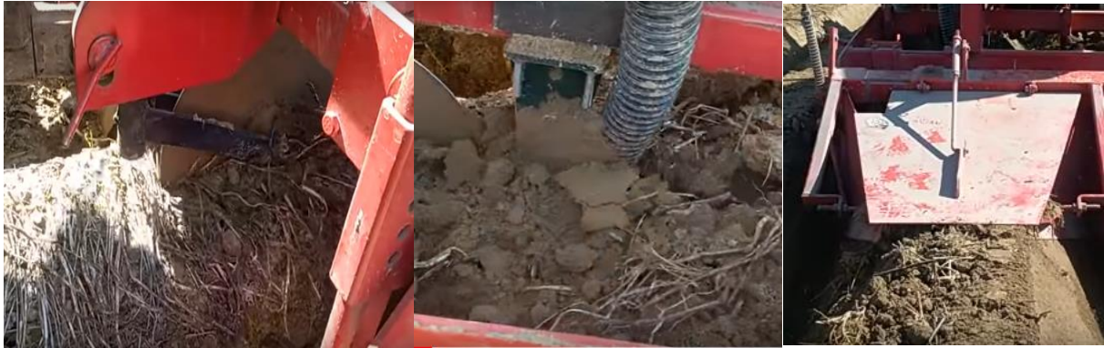
Figure 14: Photos illustrant les constituants de l'outil combiné « dent-butteuse ». Gauche :ouverture de la butte d'automne par un disque. Milieu: ouverture en profondeur de la butte par une dent; Droite: re-buttage par une cappe
