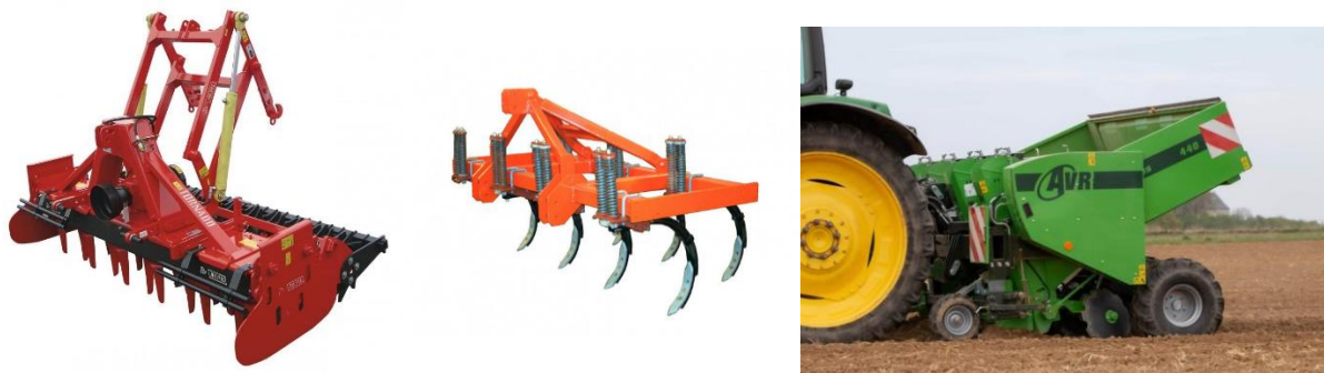
Figure 12: Photos des différents outils utilisés pour l'affinage du sol et la plantation des pommes de terre. Gauche : herse rotative à axe vertical ; Milieu : chisel lourd ; Droite : planteuse à pommes de terre classique.
