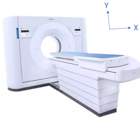
FIGURE 2.10 – Image du Phillips IQon issue du site de Phillips [15]. Le patient subit une translation vers le cercle décrit par les rayons X.
