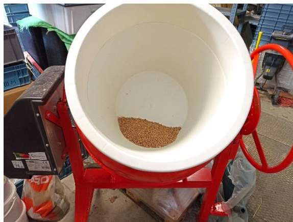
Figure 16. Bétonnière à laquelle un récipient a été fixé pour pouvoir manipuler les matériaux en profitant du mouvement rotatif de la bétonnière
