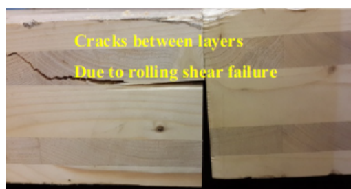
Figure 2.28 – Rupture par cisaillement de roulement.
