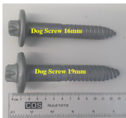
Figure 2.11 – Photo pour donner un aperçu des "dog screw", tirée de l'article présenté.
