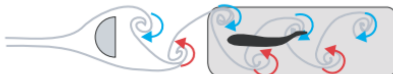
FIGURE 2.5 – Effet de la formation de tourbillons dans un écoulement turbulent sur l'efficacité de nage d'un poisson (Liao, 2007)
