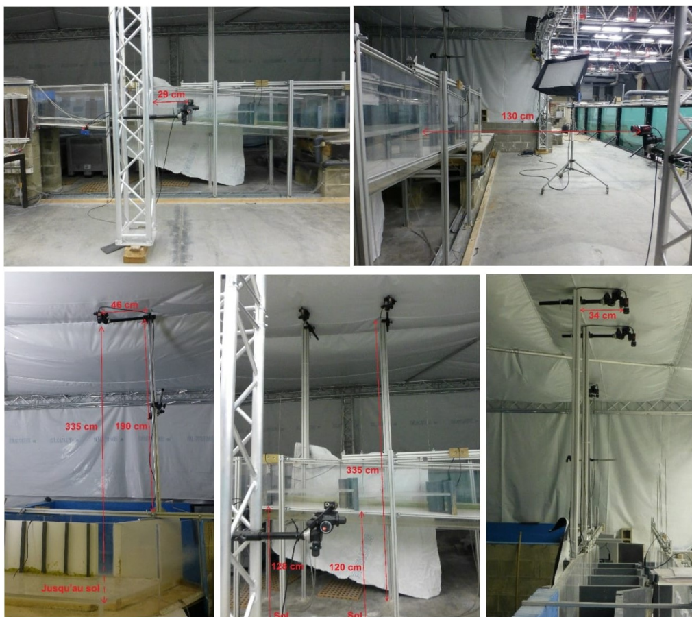
FIGURE B.1 – Illustration de la disposition des caméras le long du modèle réduit
