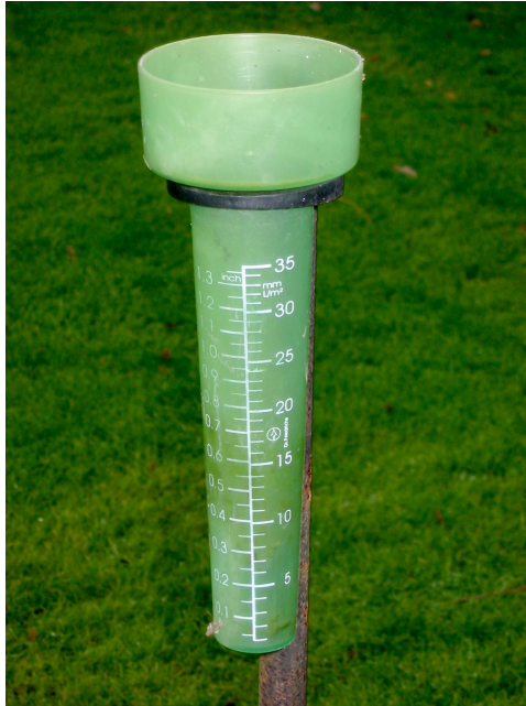
FIGURE 2.1 – Pluviomètre à lecture directe [28]
