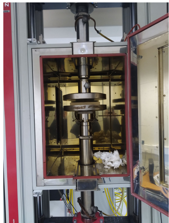
FIGURE 2.4 – Compression transverse (densification) d'un échantillon en étuve.
