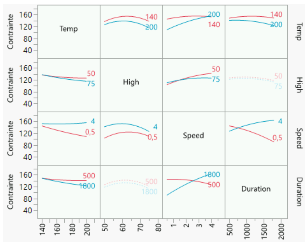
FIGURE 5.8 – Profil d'interaction des différentes variables pour prédire la valeur de la contrainte de rupture
