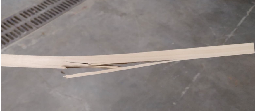
FIGURE 2.6 – Rupture d'un échantillon de flexion.
