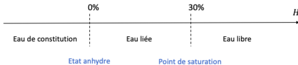
FIGURE 1.9 – Évolution de l'humidité dans le bois.
