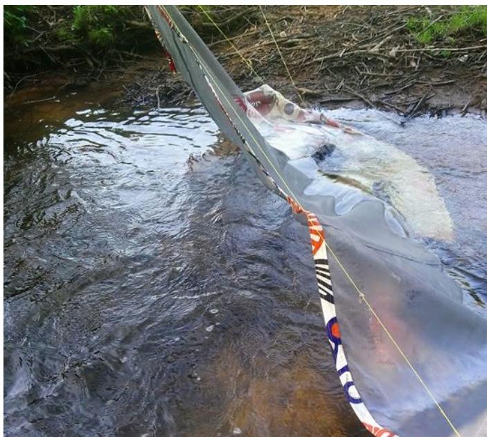
FIGURE 5 – Dispositif de mesure permettant de récolter les invertébrés de la dérive
