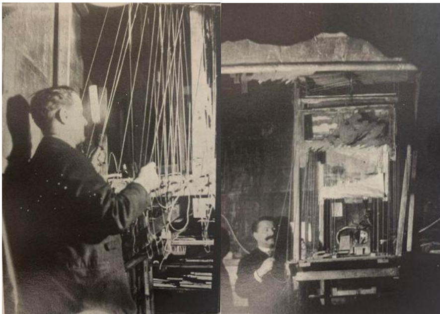
Fig.37 : Photos, aux alentours de 1986, de la source lumineuse située à trois mètres de l'écran qui peut changer d'intensité et devant laquelle sont placés des cadres, actionnés par une septantaine de fils, dans lesquels on coulisse des verres colorés ou peints et des figurines en zinc. 140
