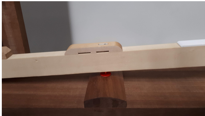
FIGURE 3.2 – Articulation entre le balancier et la touche. Cette dernière a été légèrement soulevée de manière à faire apparaître le feutre (en rouge) sur lequel elle repose.
