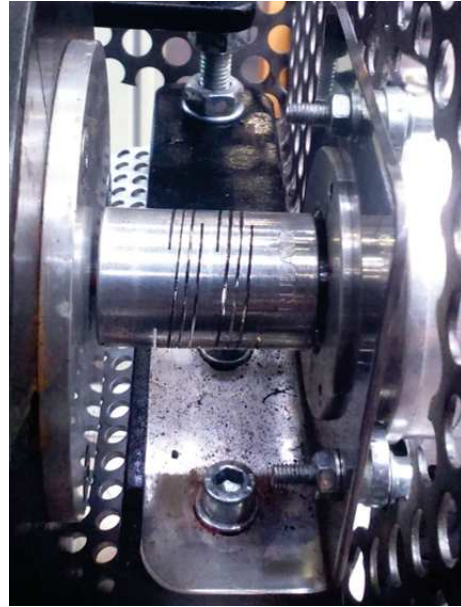
(b) Accouplement entre le moteur à gauche et le codeur angulaire à droite
