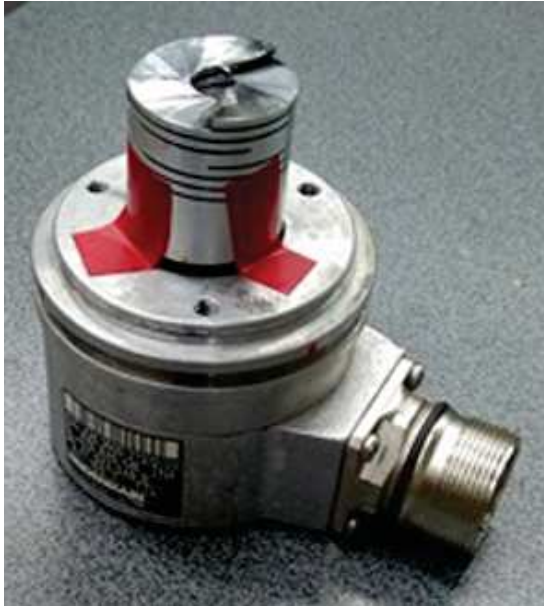
(a) Codeur angulaire et accouplement brisé
