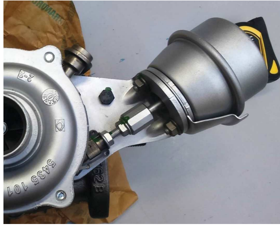
FIGURE 2.19 – Mécanisme à dépression d'origine
