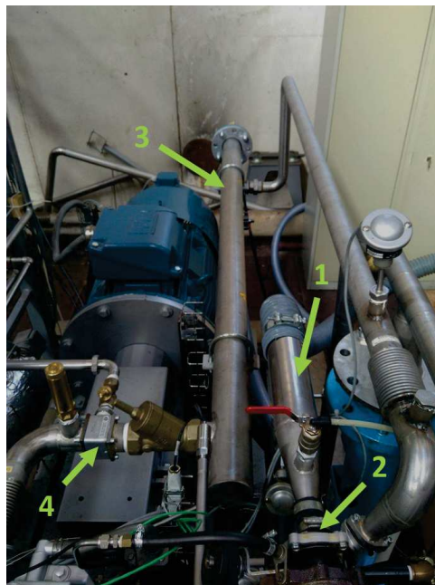
FIGURE 2.3 – (1) Mélangeur air - EGR, (2) Compresseur, (3) Résistance chauffante, (4) Mélangeur de gaz
